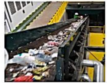
加水分解装置へ 都市ゴミを投入
